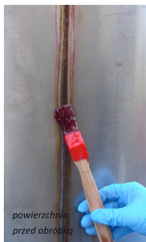
na fotografiach pokazany sposób nakładania pasty oraz efekt zmatowienia powierzchni po wytrawieniu
