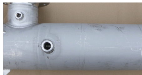
powierzchnia po wytrawieniu w ecoplus 2000
