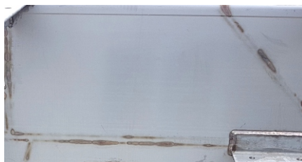
powierzchnia po obróbce w ecoclean 2000
