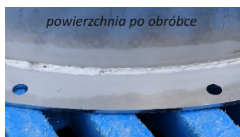
na fotografiach pokazany sposób nakładania pasty oraz efekt zmatowienia powierzchni po wytrawieniu
