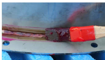
na fotografiach pokazany sposób nakładania pasty oraz efekt zmatowienia powierzchni po wytrawieniu
