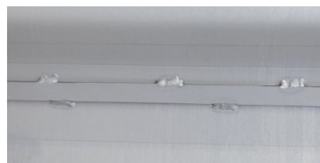
powierzchnia po wytrawieniu w ecoplus 2000
